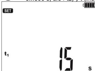
Ajuste de tiempos  $t_1...t_3$ .
