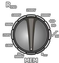
El conmutador rotativo de selección de función debe ser puesto en la posición **MEM**.
